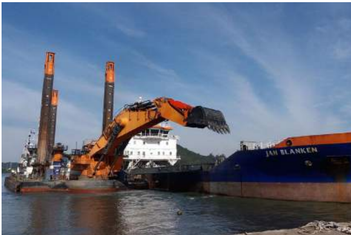
Figura 73. Conjunto de equipamentos de dragagem, sendo escavadeira e batelão com autopropulsão
