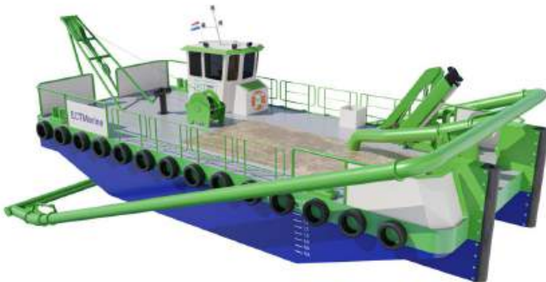
Figura 74. Sistema de dragagem por injeção de água Water Injection Dredger – WID
