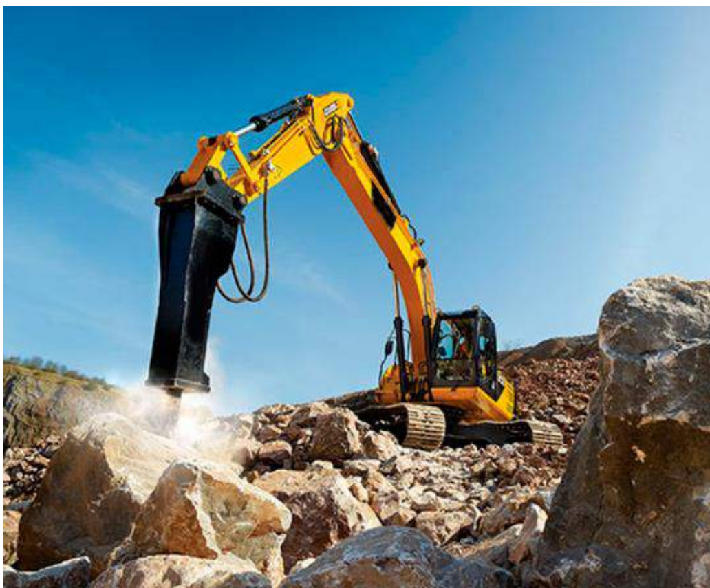
Figura 78. Escavadeira hidráulica com martelo hidráulico
