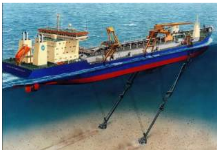
Figura 72. Dragagem autotransportadora de sucção e arrasto
