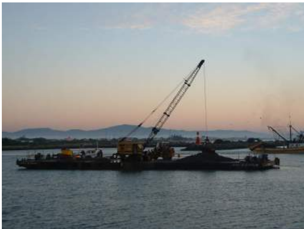
Figura 80. Conjunto flutuante, guindaste e carregadeira
